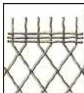
La bordure défensive, maille de 50mm en fil galvanisé et plastifié par fluidisation en diamètre de 3,0/3,6mm ou galvanisé à chaud en diamètre 3,4 ou 3,9mm.
